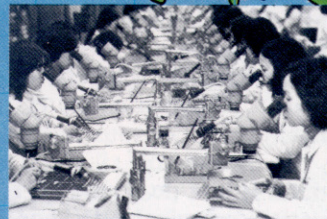
Des ouvriers qualifiés se servent de microscopes pour installer des circuits sur la carte mère.
